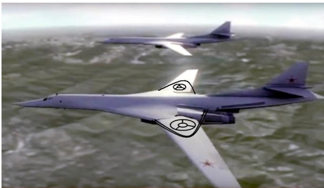
Рис.6. Схема замены у «Белого Лебедя» (Ту-160) громоздкого поворотного крыла на компактное винтокрыло с регулируемым до 0 градусов на сверхзвуковой скорости углом атаки его лопастей.
