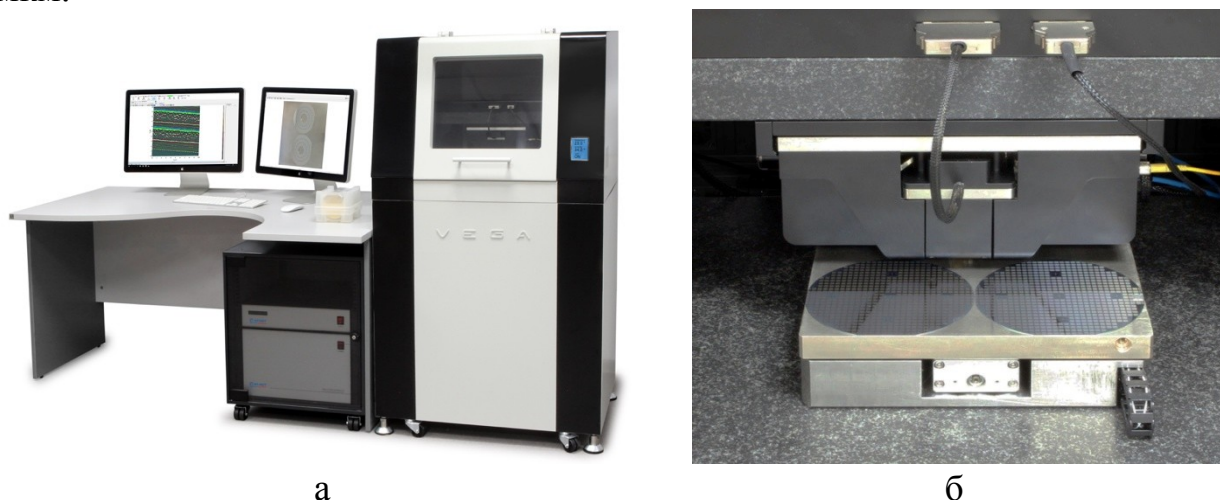
Рис. 9. СЗМ ВЕГА для исследования пластин, диаметром до 200 мм с системой термо- и акустостабилизации (а) с установленными на подвижный стол пластинами диаметром 100 мм (б). Точность поддержания температуры 5 \times 10^{-3}^{\circ}\text{C} , подавление шумов – 30 ДБ
